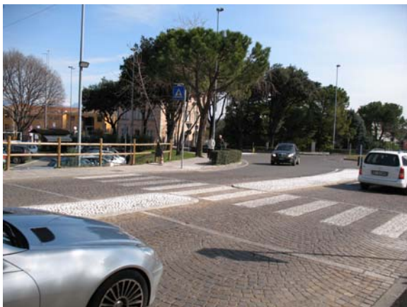
Esempio di attraversamento pedonale rialzato
