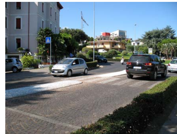
esempio di attraversamento pedonale rialzato
