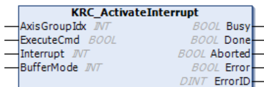
Fig. 6-35: Function block KRC_ActivateInterrupt
