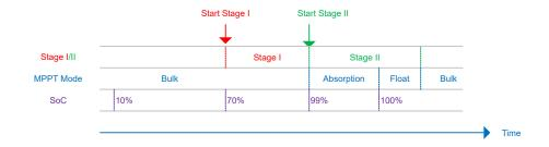
Der Start SoC Wert für Stage-I ist konfigurierbar. Der Start SoC Wert für Stage-II nicht. Stage-II wird aktiv, wenn der MPPT in den Absorption-Mode wechselt.
