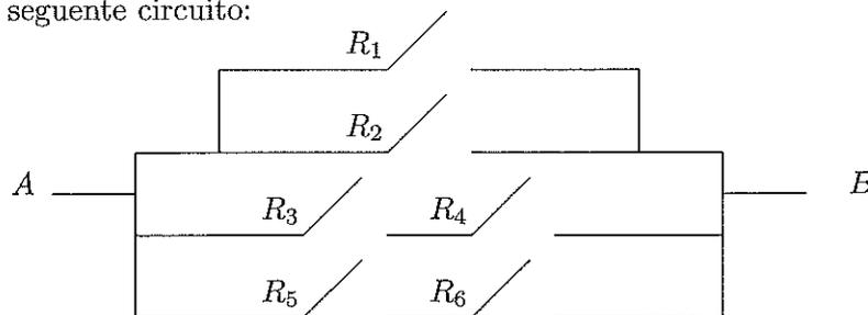
Ogni relè (interruttore)  $R_1, R_2, \dots, R_6$  è chiuso con probabilità  $1/3$ , indipendentemente dagli altri.
